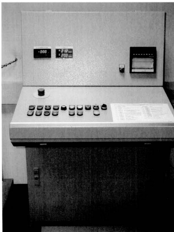
Bild 3a: Prüfstand-Steuerung (Drucksteuerung)
