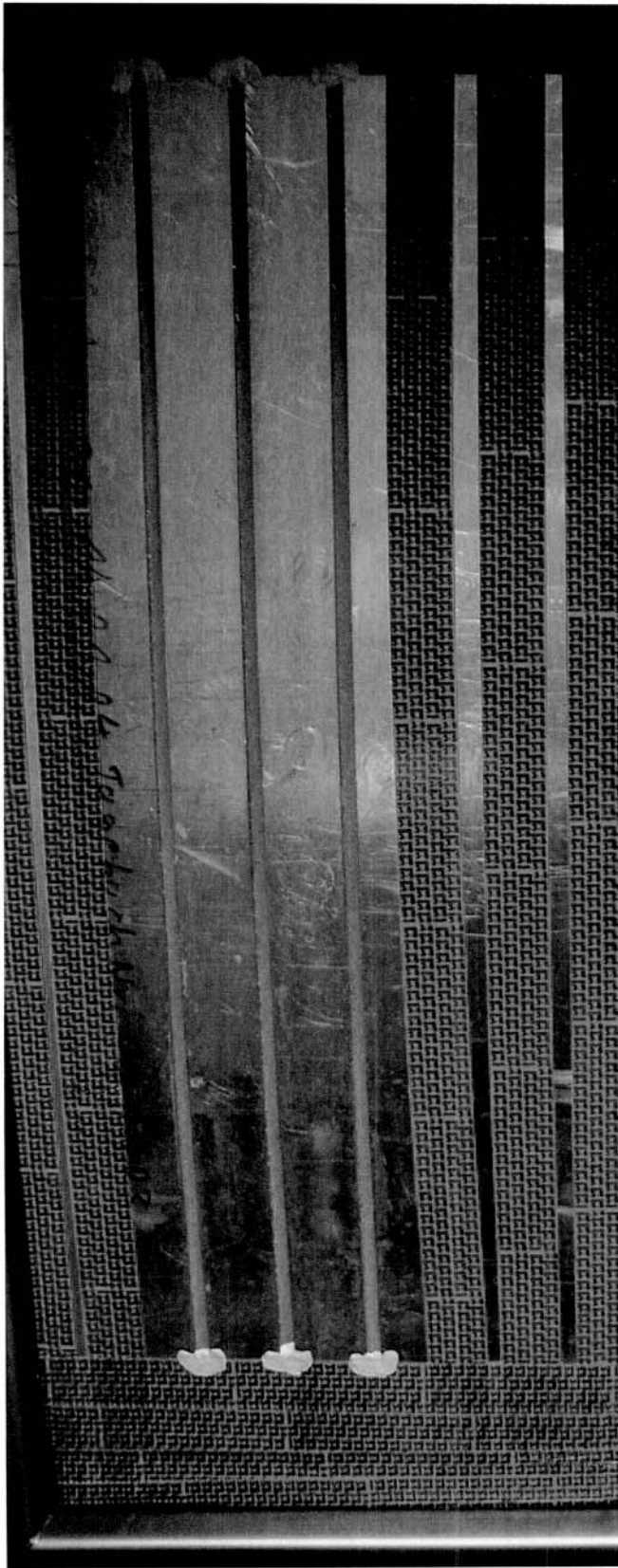
Bild 4: Versuchskörper mit den eingebauten Dichtbändern
